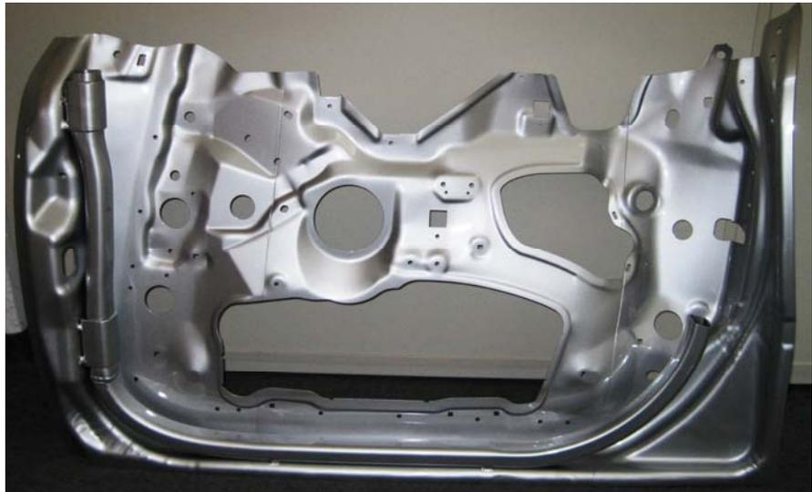
**Bild:** Türinnenteil der Magnesium-Autotür mit tragendem Rahmen
